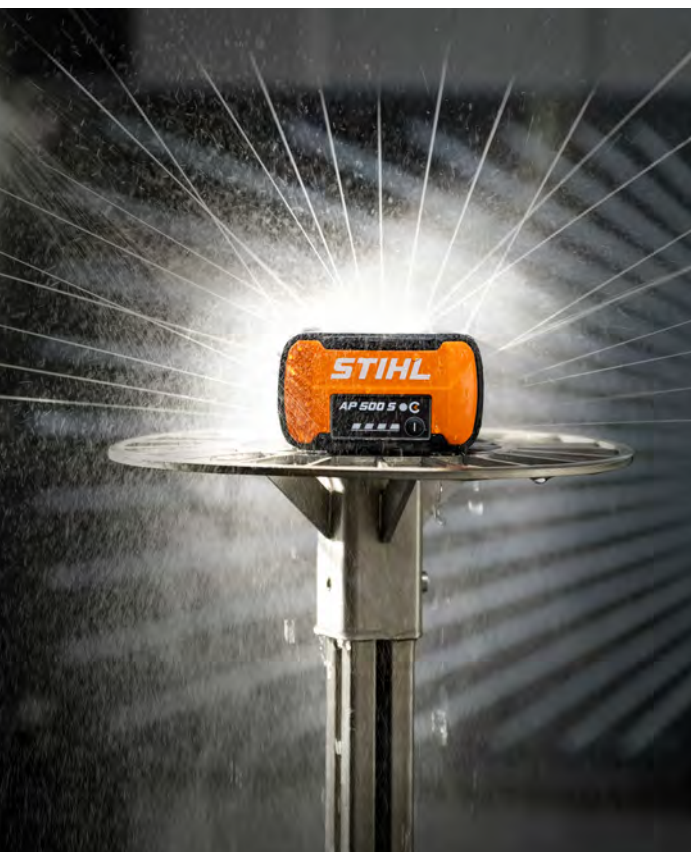
Bei dem Beregnungstest kann die Robustheit des Akku-Packs bei der Anwendung im Regen nachgewiesen werden.
